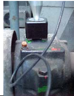
MEDIR SOBRE EL RODAMIENTO O APOYO
