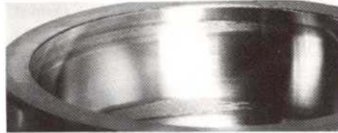
La ilustración muestra el aro exterior de un rodamiento de rodillos dañado por el deslizamiento debido a una excesiva rigidez de la grasa. Las marcas de desgaste indican que los rodillos redujeron su velocidad o se pararon completamente en la zona sin carga. Cuando volvieron a entrar en la zona de carga, fueron obligados a acelerar rápidamente bajo carga. Consecuentemente los rodillos rompieron la película de lubricante y se produjeron los daños.
